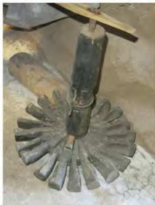
Fig. 17 : Imedghassen. L'ancien roudet en bois surmonté de l'arbre et de l'anille de fer qui s'encastrait dans la rainure située sous la meule tournante. Les deux parties haute et basse de l'arbre sont assemblées avec deux encoches alternées et opposées et maintenues par un anneau de fer. Cliché J.-P. Laporte, 2014.
