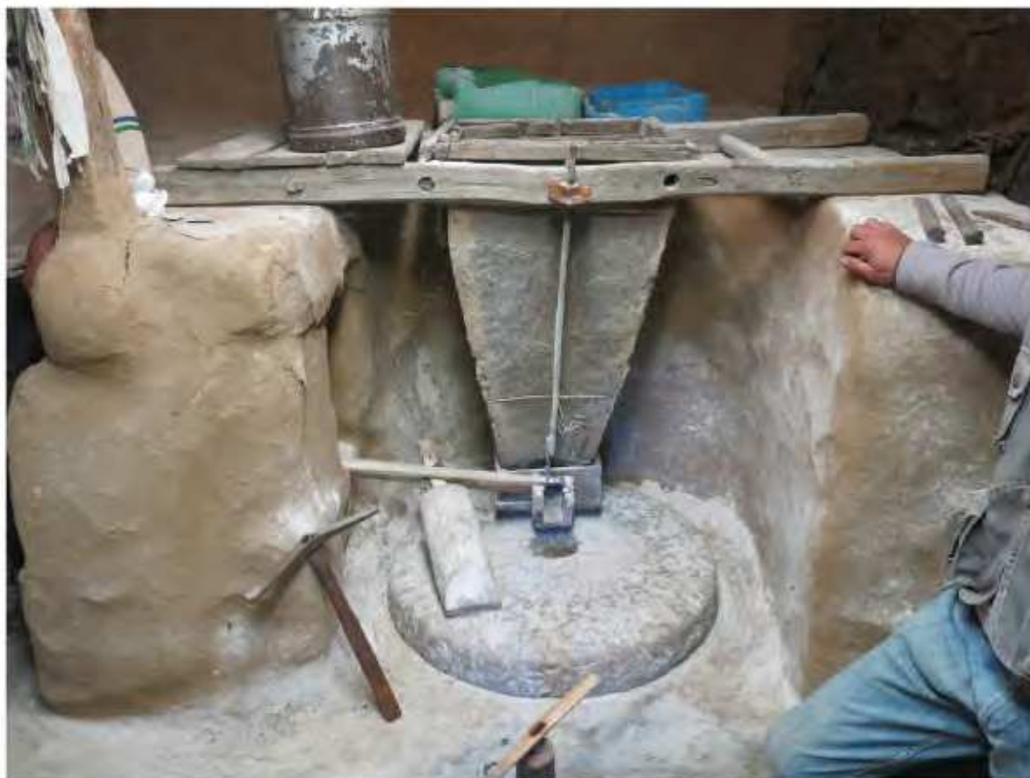
Fig. 5 : La partie supérieure du moulin d'Imedghassen (Kabylie). Cliché J.-P. Laporte, mai 2014. Noter le patin frottant sur la meule supérieure. La meule inférieure, encastrée dans le sol, est peu visible.
